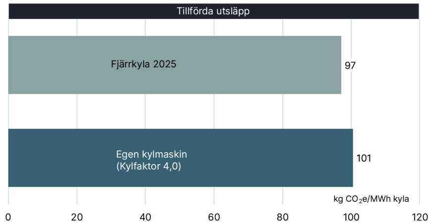
Figur 12 En fjärrkylakunds klimatpåverkan under 2025 i Kalmar i jämförelse med en ny enskild kylmaskin.
